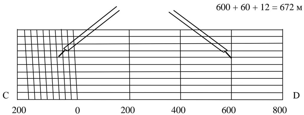
Рис. 2. Определение длины линии по поперечному масштабу
