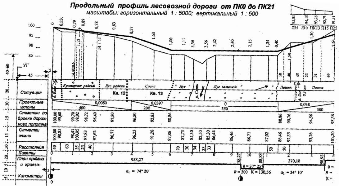
Точка пересечения проектной линии с линией земли называется точкой нулевых работ, здесь  $h_{раб}=0$ . При проектировании по профилю определяют расстояние от точки нулевых работ до ближайших пикетов или плюсовых точек по формулам
