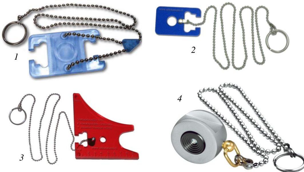
Рис. 2.12. Інструменты для вызначэння абсалютнай паўнаты дрэвастою
