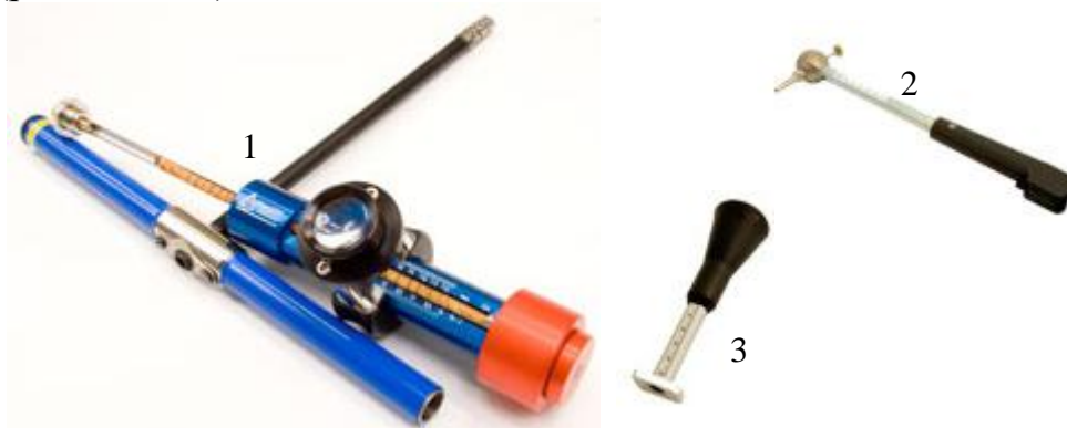
Рыс. 2.19. Адмысловая прадукцыя кампаніі Haglof AB для вызначэння прыросту ствала дрэва, таўшчыні кары
